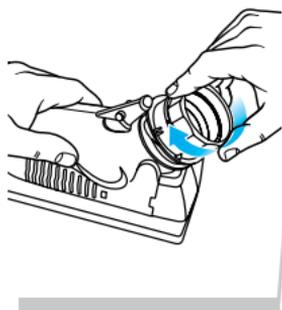
En s'assurant que le mandrin demeure fermement appuyé contre le guide-came, tournez le mandrin d'un demi-tour vers la droite, vers le prochain guide d'affûtage. Tournez de guide en guide dans un mouvement uniforme jusqu'à ce que le foret soit affûté. Pour affûter uniformément les deux côtés du foret, effectuez toujours un nombre pair de demi-tours de mandrin. Le nombre de demi-tours requis pour l'affûtage du foret varie selon sa taille.
