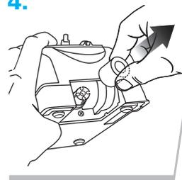
Retirez la meule usée de l'arbre en la tournant légèrement et en la levant. Posez la meule neuve et posez de nouveau le dispositif de maintien et les deux vis. Ne serrez pas trop les vis de fixation. Retirez la clé et remplacez le couvercle de la meule avant de mettre la machine en marche.
